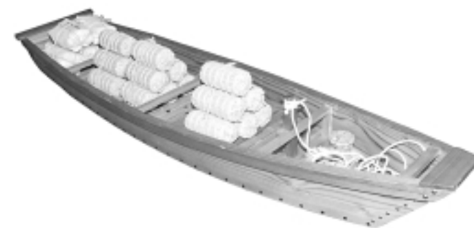
長さ三間(約5.4m)幅七尺(約2.1m)で、底が平らな舟が3隻1組で運航。1隻に13俵の米を積んでいた。敦賀からの上り荷は米のほか、麦、塩、ニシン、昆布など、下り荷はお茶、酒、煙草、呉服類が主に運ばれていた。(写真は川舟の模型)
