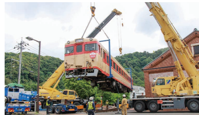
▲2台のクレーンを使って吊上げられるキハ28形気動車
