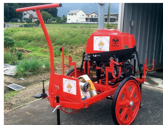
▲整備した消防ポンプ
