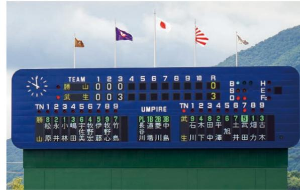
総合運動公園野球場のスコアボードの改修工事が完了し、7月10日にお披露目されました。単色の色板を反転させる「磁気反転方式」からカラー表示が可能な「LED方式」に更新され、球速や投球数などを表示する機能が加わりました。旧スコアボードは2019年ごろから不具合が発生するようになり、スコアボードが使用できない期間には、敦賀工業高校野球部が中心となって製作した仮設スコアボードが中継ぎの役割を果たしました。今後、この新しくなったスコアボードが試合を盛り上げていくことが期待されます。
