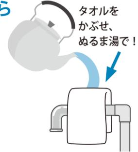
▲熱湯を急にかけると、水道管が破裂する場合があります。必ずぬるま湯をかけるようにしてください。
