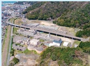
天筒浄化センターは、昭和58年度に供用を開始した下水処理場です。この浄化センターには1日当たり平均約25,000m<sup>3</sup>(小学校のプール約80杯分)の汚水が流れてきており、24時間365日休むことなく汚水をきれいにして海に返したり、水処理の過程で発生する汚泥を処理しています。
