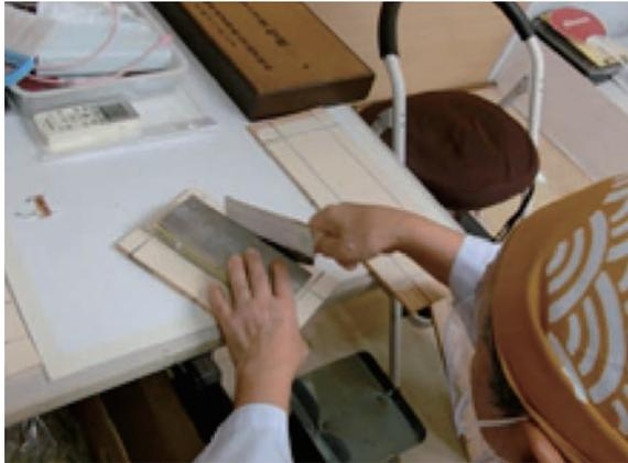
写真 34 ステンレス製型板を用いて切る
