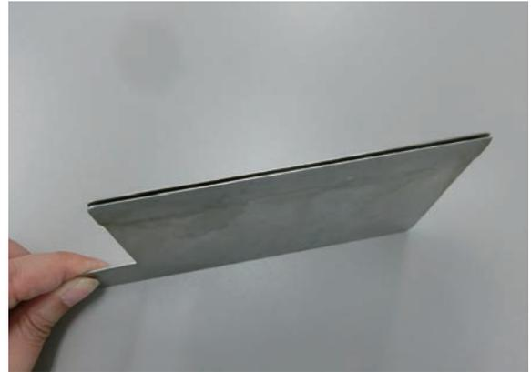
写真 28 刃を挟む隙間
