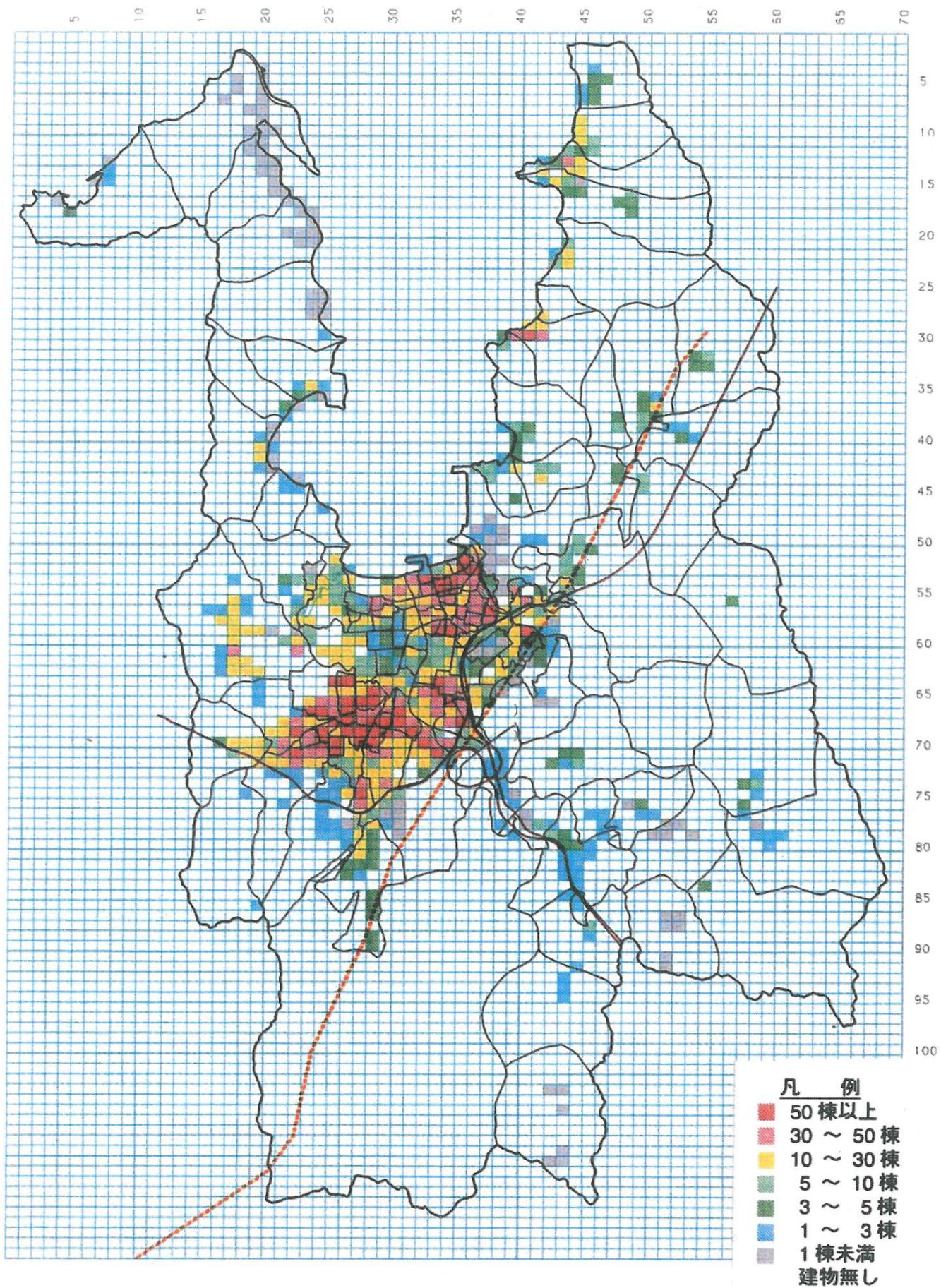
付図4 建物被害予測図（木造全壊棟数）〔敦賀断層〕
