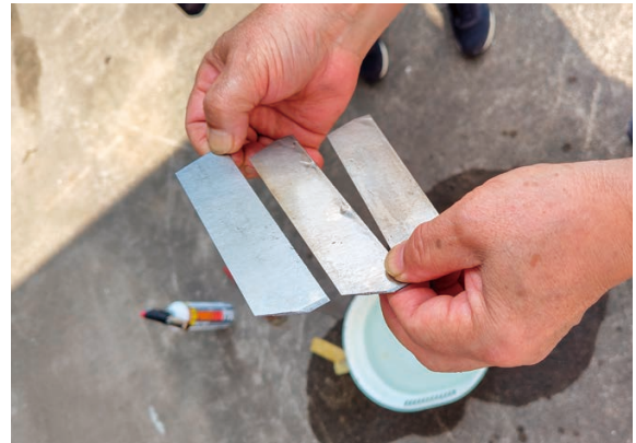
写真14 焼き直しをした正博の刃（右2枚）と していない正博の刃（左1枚）
