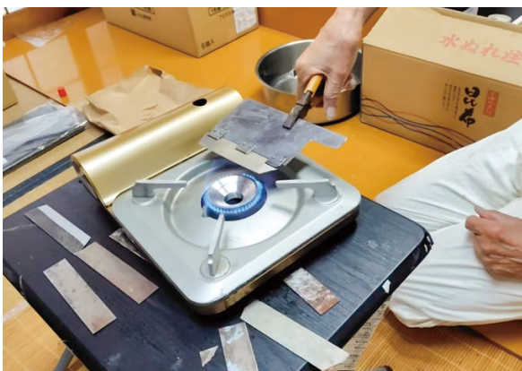
写真15 コンロを使った焼き直し
