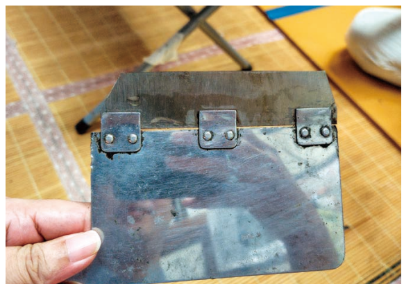
写真16 焼き直しをした正博の刃
