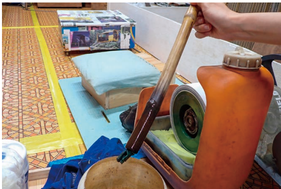
写真26 研いだ後の刃先に水をつける道具
