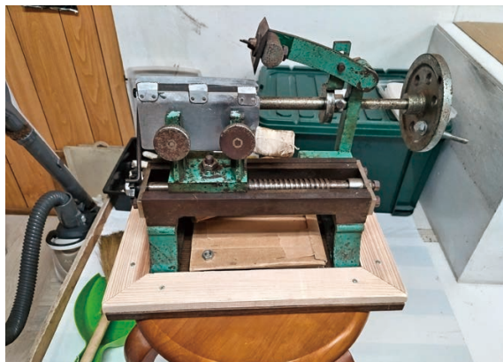
写真10 とろろ昆布切削用の目打ちの機械
