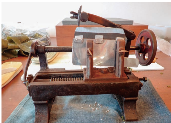
写真9 とろろ昆布切削用の目打ちの機械
