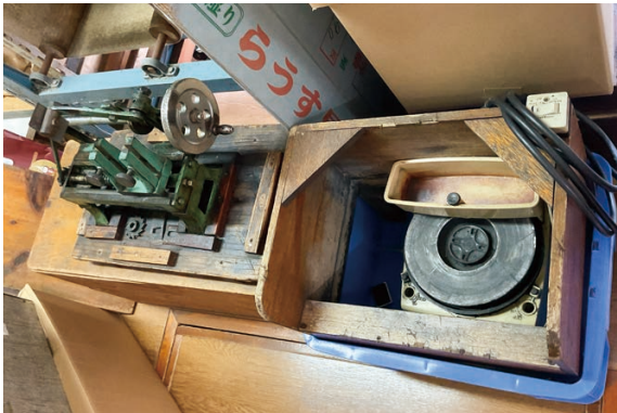
写真 54 目打ちの機械と砥石
